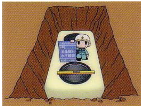
本体据付、水平確認
