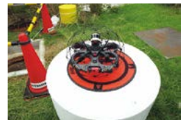
点検用ドローン
