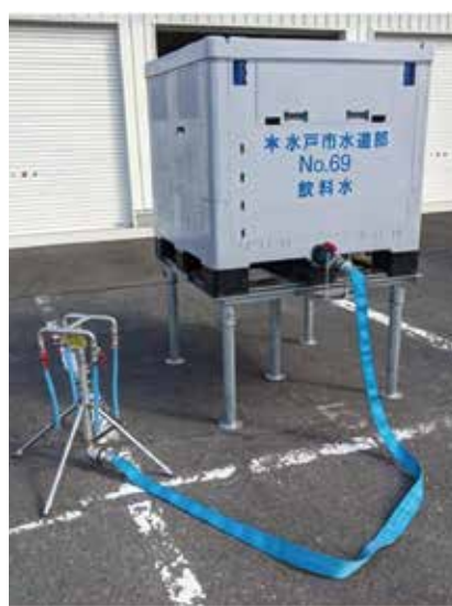
図4-3-3 応急給水用給水タンク
