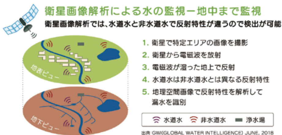
図4-5-2 人工衛星を活用した漏水調査の仕組み
