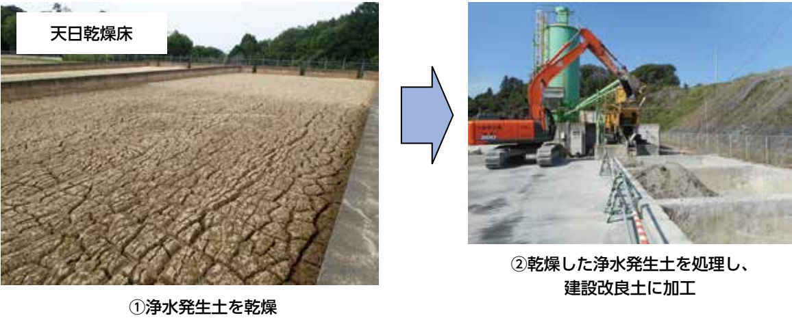
図4-6-3 乾燥中の浄水発生土とリサイクルの例
