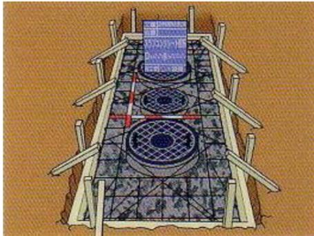
上部スラブコンクリート 型枠、配筋
