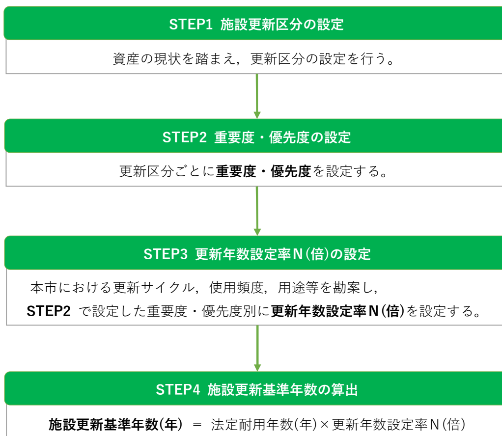
図 3-2 施設更新基準設定フロー
