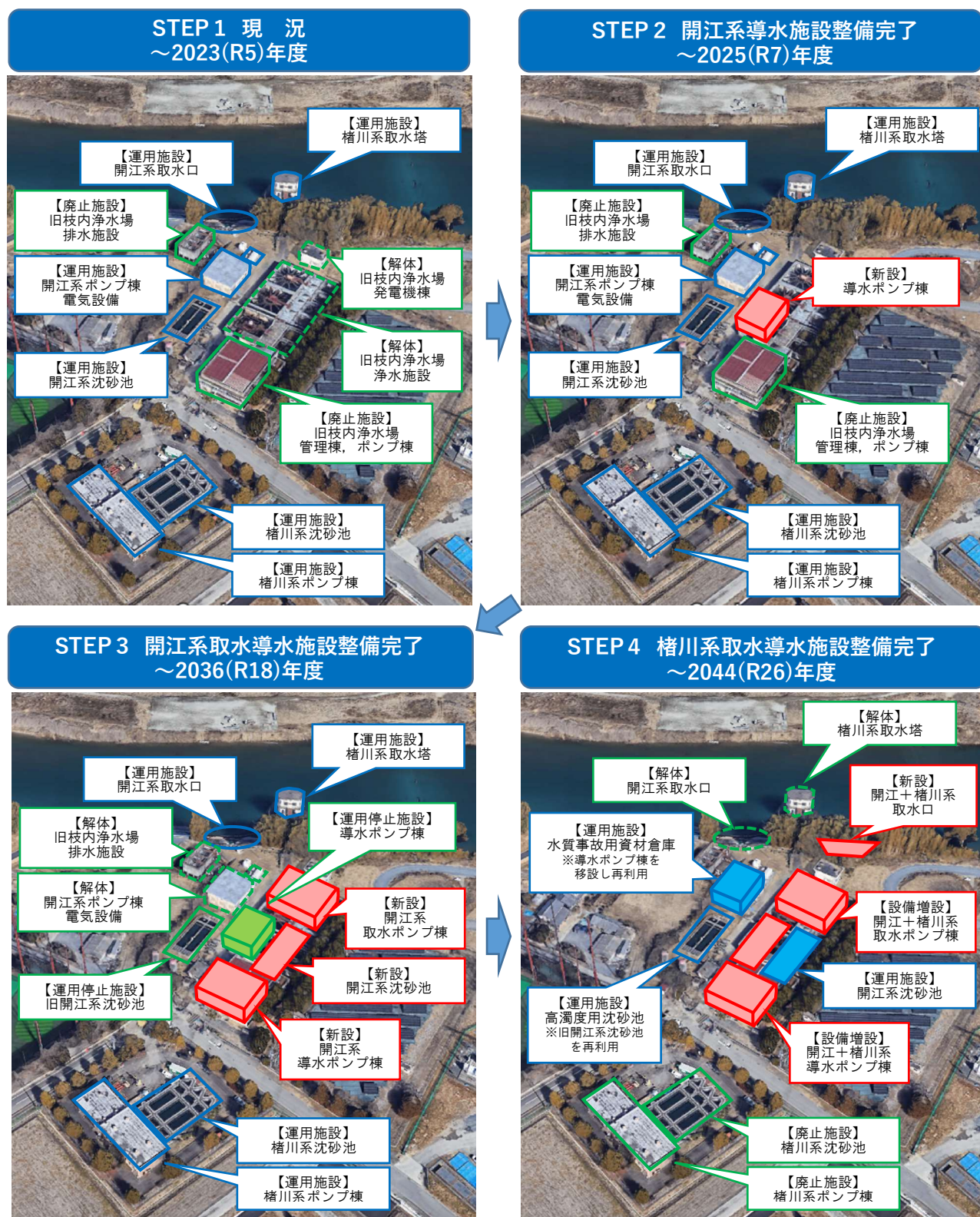
図 4-5 取水導水施設再編整備 概要図
