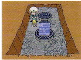
⑬埋め戻し完了、つき固め
