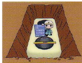
⑩本体据付、水平確認
