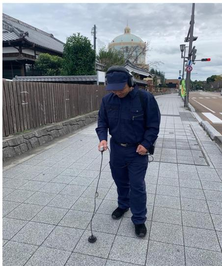
図 4-5-4 音聴による漏水調査の様子
