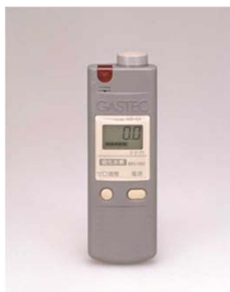
図 11 拡散式硫化水素計
