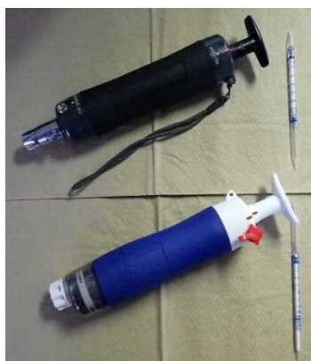
図 10 検知管法ガス採取器
