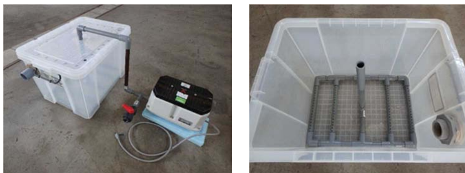
図 4 送気式ばっ気装置(実証試験器)
