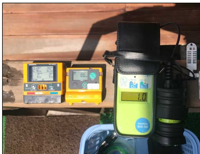
図 24 拡散式及び吸引式硫化水素計
