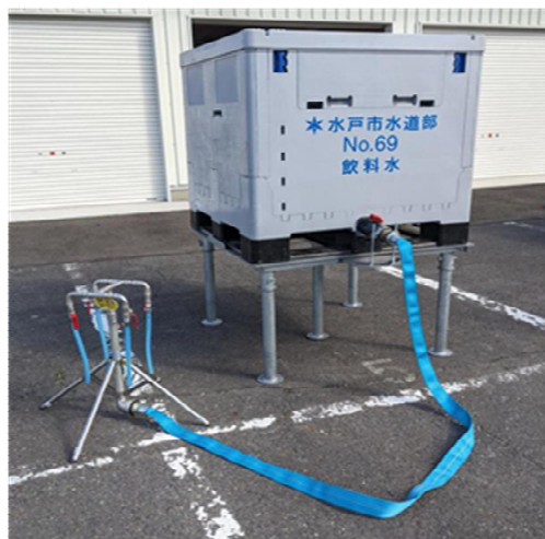
図 4-3-3 応急給水用給水タンク
