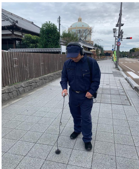
図 4-5-4 音聴による漏水調査の様子
