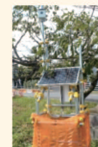
簡易型河川監視カメラ
