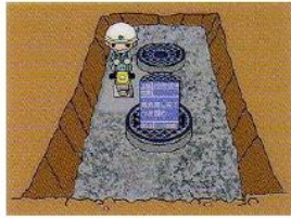
⑬埋め戻し完了、つき固め
