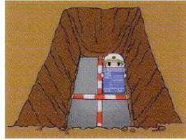
⑦基礎コンクリート 出来形検測 L=〇〇, W=〇〇
