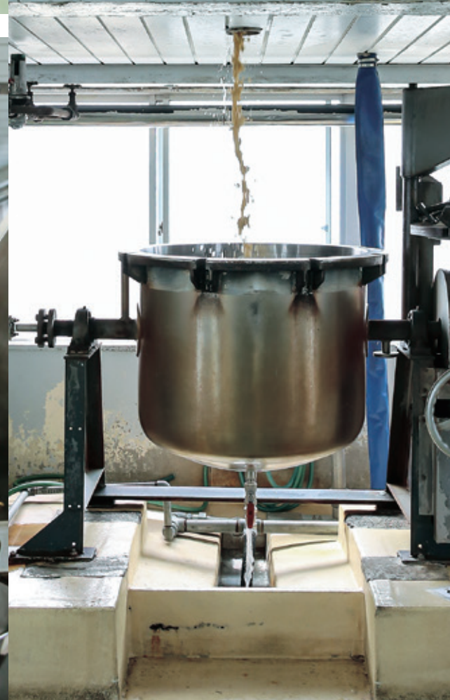
中2階で浸漬した豆を、床に通したパイプを通じて1階の蒸煮釜へ流し入れる
