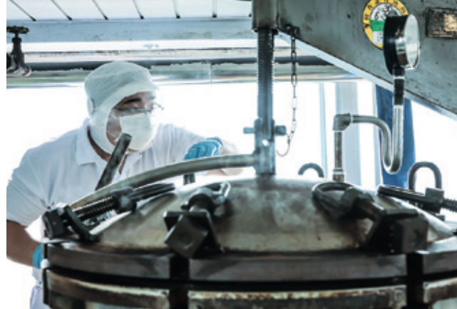
蒸煮の時間や圧力は、大豆の状態を見ながらその都度調整する
