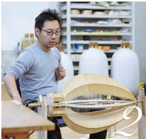
次に型を専用の機械にセットし、PET樹脂線の骨を型につくられた溝にそって等間隔に、同じテンションで巻きつけていく。
