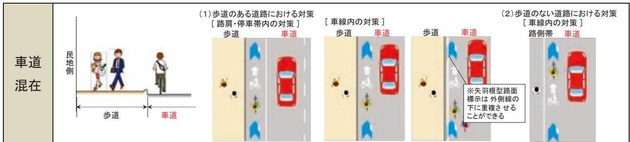
図 4-8 車道混在の基本的な整備形態（イメージ）
