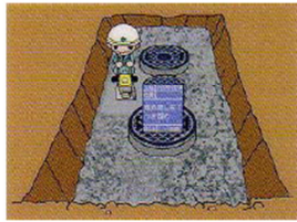
⑬埋め戻し完了、つき固め
